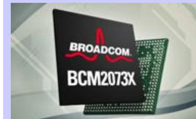
Компания Broadcom разработала референсный дизайн для микросхемы BCM20730, который обещает беспрецедентную энергоэффективность. Некоторые из Bluetooth-гаджетов смогут работать без замены батареек в течение всего срока эксплуатации.
