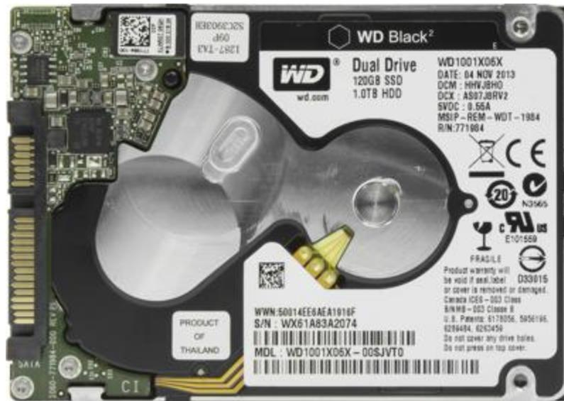
При подключении диска к компьютеру, BIOS определяет его как два отдельных накопителя на 120 ГБ и 1 TB. Стоит отметить, что операционная система изначально находит лишь раздел SSD, и потому для разбиения HDD потребуется предварительно загрузить с сайта производителя специальную утилиту.
