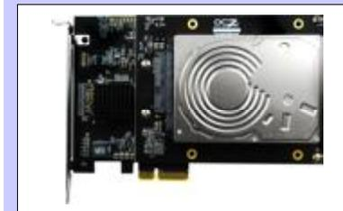
OCZ Technology выпустила на рынок гибридный накопитель RevoDrive Hybrid. Гибридность продукта состоит в том, что он представляет собой сочетание твердотельного накопителя с интерфейсом PCI Express и жесткого диска большой ёмкости, который выполнен в форм-факторе 2,5 дюйма. Специальный механизм позволяет переносить часто используемые файлы на SSD. Остальная часть информации хранится на HDD.
