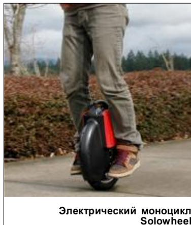
лядит Solowheel довольно минималистично — только колесо, корпус с ручкой сверху и откидывающиеся подножки. Весит он всего 25 фунтов, при этом может ехать вместе с человеком весом 160 фунтов со скоростью до 10 миль в час в течение 2 часов при полном заряде литий-ионного аккумулятора. Диаметр колеса 16 дюймов, мощность электромотора 1000 ватт. Благодаря компактным размерам 17 x 5 x 19 дюймов этот моноцикл удобно брать с собой в автобус или поезд, а хранить можно прямо под рабочим столом. По-
