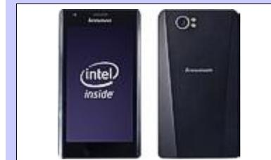
Недавно в китайские магазины приехал Lenovo LePhone K800 — первый из смартфонов, получивший в качестве **“моторчика”** процессор от компании Intel. Intel Atom, которым обладает новинка, работает с тактовой частотой 1.6 ГГц. Как и ожидалось, данный чип может обеспечить очень высокую производительность смартфона. Среди достоинств гаджета — возможность быстрого серфинга по Сети, а также — многозадачность и сверхбыстрое переключение между запущенными программами.
