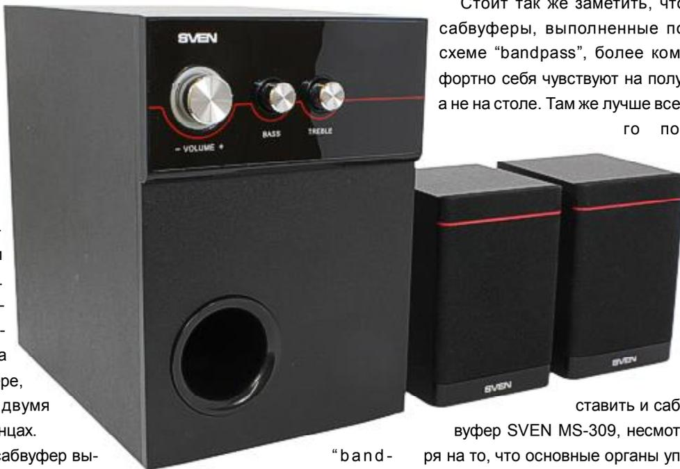
“bandpass”. Это означает, что фазоинверторный ящик разделен внутри перегородкой, в которую, в свою очередь, встроен 100-миллиметровый диффузор низкочастотного динамика. При этом активной стороной он направлен в камеру, куда выходит труба фазоинвертора. Диаметр ее составляет 50 мм.
