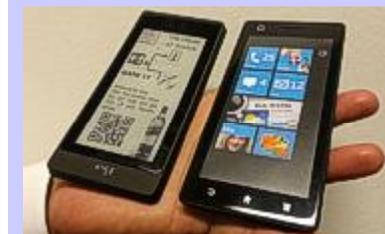
E Ink Corporation, известный производитель электронных книг, привез на выставку IFA 2012 диодный гаджет, обладающий одновременно характеристиками и смартфонов, и “читалок”. Прототип гибридного устройства обладает двумя экранами, один из которых располагается на передней панели гаджета, а второй — на тыльной его стороне. Оба дисплея сенсорные, однако один из них — обычный жидкокристаллический экран, второй же — монохромный, и создан по технологии E Ink.
