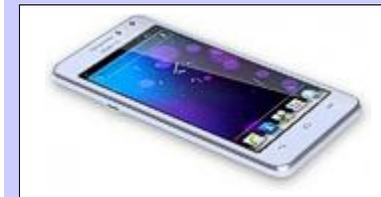
Среди новинок, представленных на выставке IFA 2012, компания Huawei продемонстрировала и новый мобильник Ascend G600. У этого устройства сравнительно большой 4.5” сенсорный экран, обладающий разрешением в 960x540 пикселей. Для защиты дисплея используется прочное стекло Gorilla Glass. Кроме того, мобильник может похвастаться двухъядерным процессором Qualcomm, тактовая частота работы которого составляет 1.2 ГГц. Количество оперативной памяти смартфона — 768 Мб.
