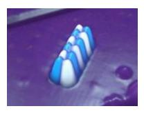
тывающего и записывающего устройства. В качестве носителя информации были использованы атомы железа, сгруппированные на подложке из нитрида меди в двухрядные блоки по шесть атомов в каждом ряду. Восемь таких блоков (однобайтный домен) занимают площадь 4x16 нм — это в сотни раз меньше, чем байтные блоки на поверхности современныхжестких дисков.
