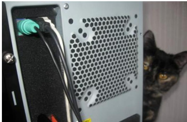
Для начала вычищаем компьютер “до блеска”. Потом проверяем тонкой полоской бумаги все места, где компьютер “сосет” воздух.
